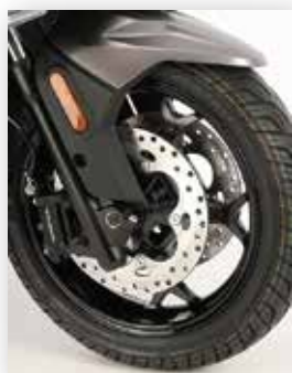
DOBLE DISCO DELANTERO CON ABS
