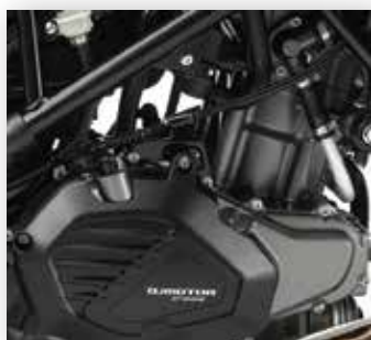
MOTOR BICILÍNDRICO 554 CC DE 8 VÁLVULAS
