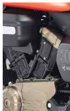
MOTOR BICILÍNDRICO V-TWIN DOHC 8 VÁLVULAS
